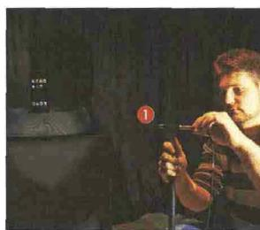
Per le misurazioni acustiche viene utilizzato un microfono Brüel & Kjær 1. I tecnici analizzano il segnale usando un sistema di misurazione Rhode & Schwarz 2 ad alta precisione, dal costo di circa 30.000 euro
